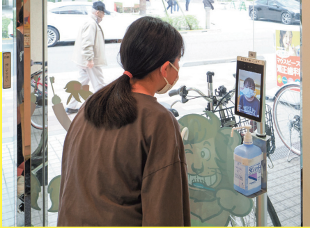
医院入口の非接触検温器。スリッパを脱いですぐに確認できる位置に設置されている。高さは子供の身長に合わせてある。
